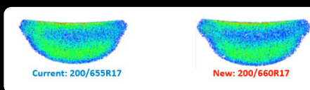
Kontaktfläche bei 50° Schräglage mit einer Last von 1200N und 1,80 bar Luftdruck
