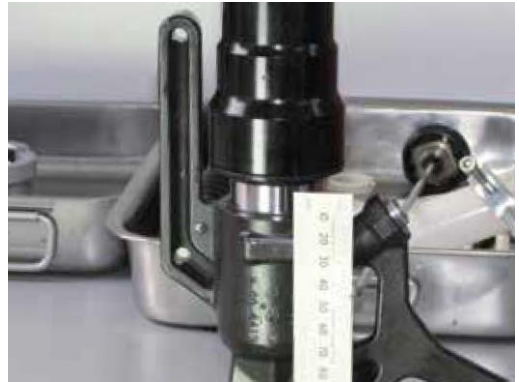
Federweg vermessen 2: Gabel bis auf den Hydrostop einfedern und den Abstand zum Gabelfuß messen
