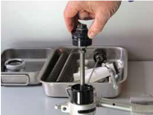
Federweg vermessen 1: Gabelstopfen mit Öl aber ohne Feder montieren und im Standrohr verschrauben
